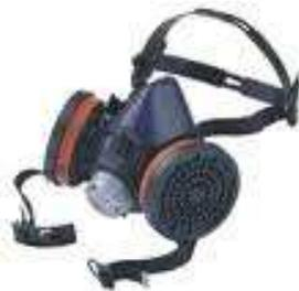
Sono dispositivi riutilizzabili, che coprono solamente bocca naso e mento, dotati di valvola di espirazione. Sulla semimaschera vengono inseriti uno o più filtri sostituibili, destinati a trattenere gli inquinanti presenti nell'aria. La struttura è di materiale elastico al fine di garantire una buona tenuta sul viso.
